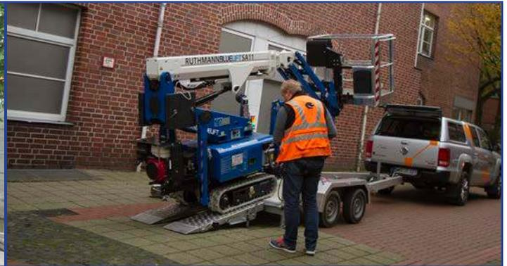
Zum Kauf der BLUELIFT bietet **RUTHMANN** parallel die Lösung für die Transportaufgabe einer Raupenbühne. Viele **RUTHMANNBLUELIFTS** können mit Standard-Anhängern transportiert werden.
